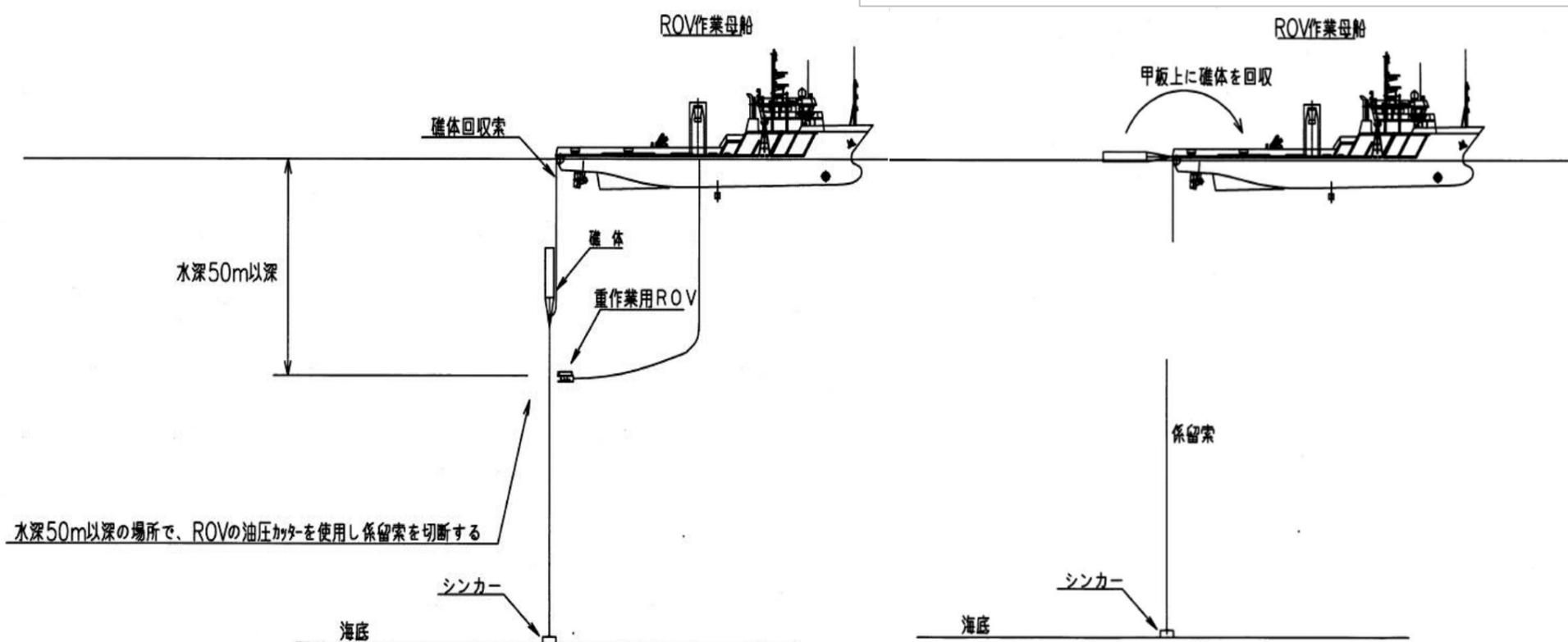
ROV(無人潜水探査機)を潜行させ礁体にワイヤーを取付けます。
